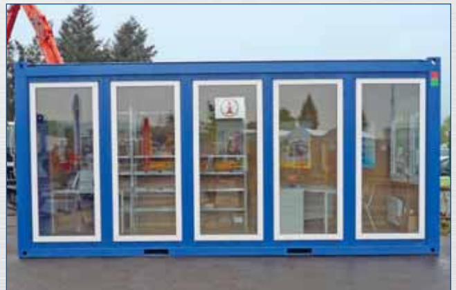
Przeszklenie stałe 945x2040 lub 2250mm przy wysokości wewnętrznej 2540 mm i 2700 mm
