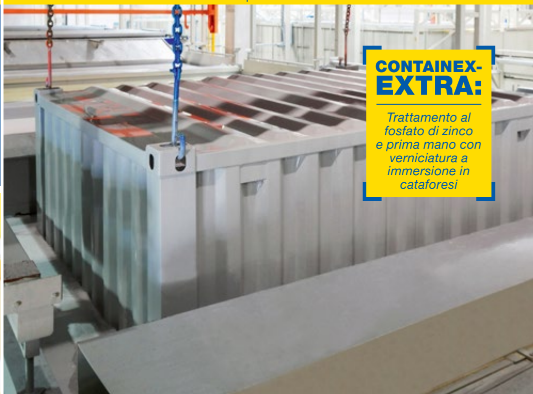
Trattamento al fosfato di zinco e prima mano con verniciatura in cataforesi
