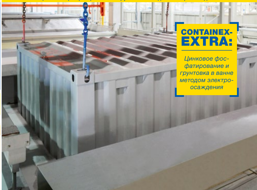
Цинковое фосфатирование и грунтовка методом электроосаждения
