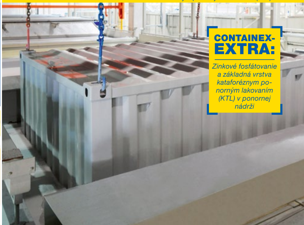
Zinkové fosfátovanie a základná vrstva kataforéznym ponorným lakovaním (KTL)
