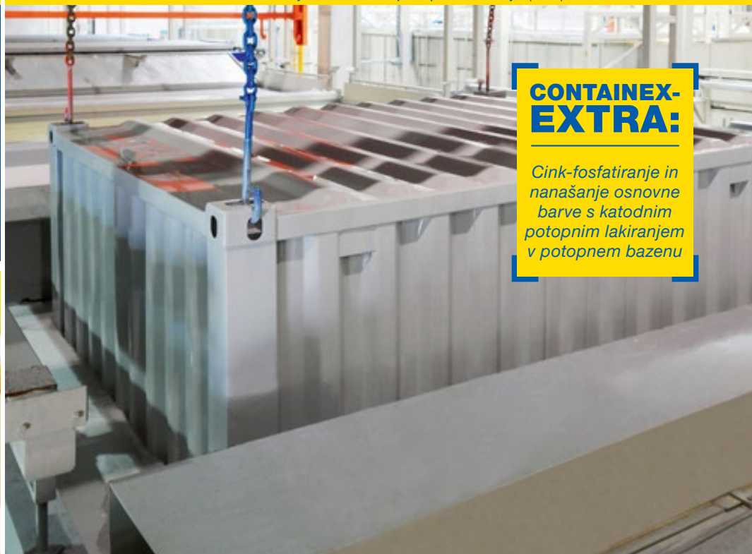
Cink fosfatiranje in katodno potopno lakiranje (KTL)
